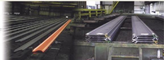
Рис. 2. Параметры шпунта и процесс прокатки плоской шпунтовой сваи PS 31.
