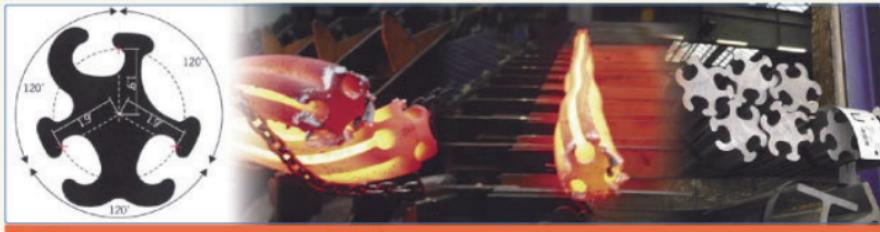
Рис. 3. Параметры шпунта и процесс вытяжки шпунта SWC 120.
