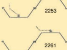
Сваи приведенной конфигурации могут быть поставлены как двойными, так и одиночными. Все эти конфигурации также могут быть получены с профилями С 14, ОМЕГА 18 и ДЕЛЬТА 13. Угловые профили соединяют и приваривают, отступая 200 мм от верха свай.
