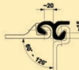
Угловые профили соединяют с основной шпунтовой сваей в соответствии с EN 12063.
