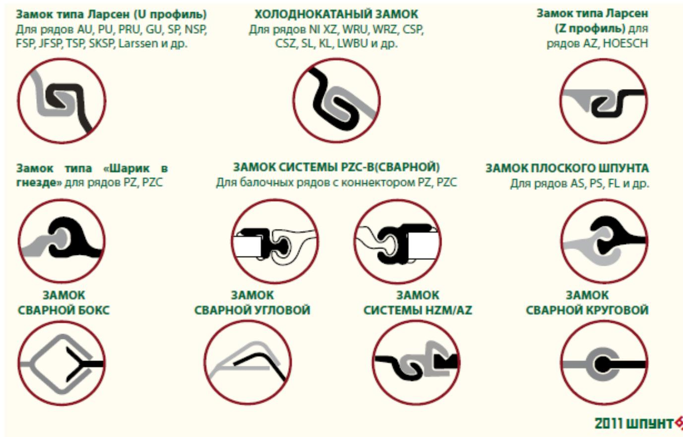
**РЕМ:** Принципиально важно различать два способа холодной деформации стали: холодный прокат в валках и холодный изгиб на прессе. Здесь имеем в виду только холоднокатаные (Х\К) в валках шпунты.
