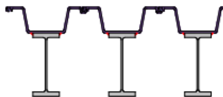
Односторонняя РШС. Спецпрофиль - г\к балка. ПФ и ПС завеса - г\к шпунт с несимметричными замками.
